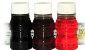
Von links nach rechts: vor der Kraftstoffreinigung, nach dem 1. Schritt, nach der kompletten Reinigung.
